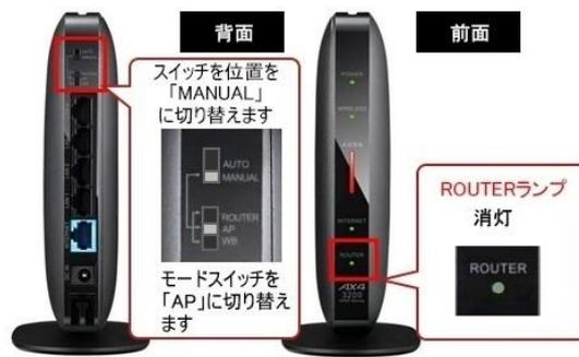
ルーターを壁の端子と LAN ケーブルで繋いだら、ルーターの背面にあるスイッチを図のように MANUAL（マニュアル）にしてください。
